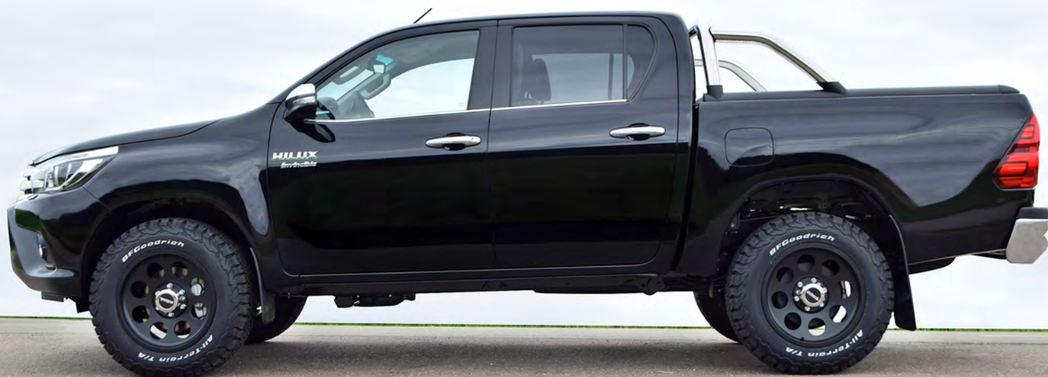
Disky/Wheels LEGACY FORGED 18x9 matt černé s pneu. BFGoodrich All-Terr T/A Nerezový leštěný rám zadní 76 mm /Sports bar stainless steel 76 mm handpolished
