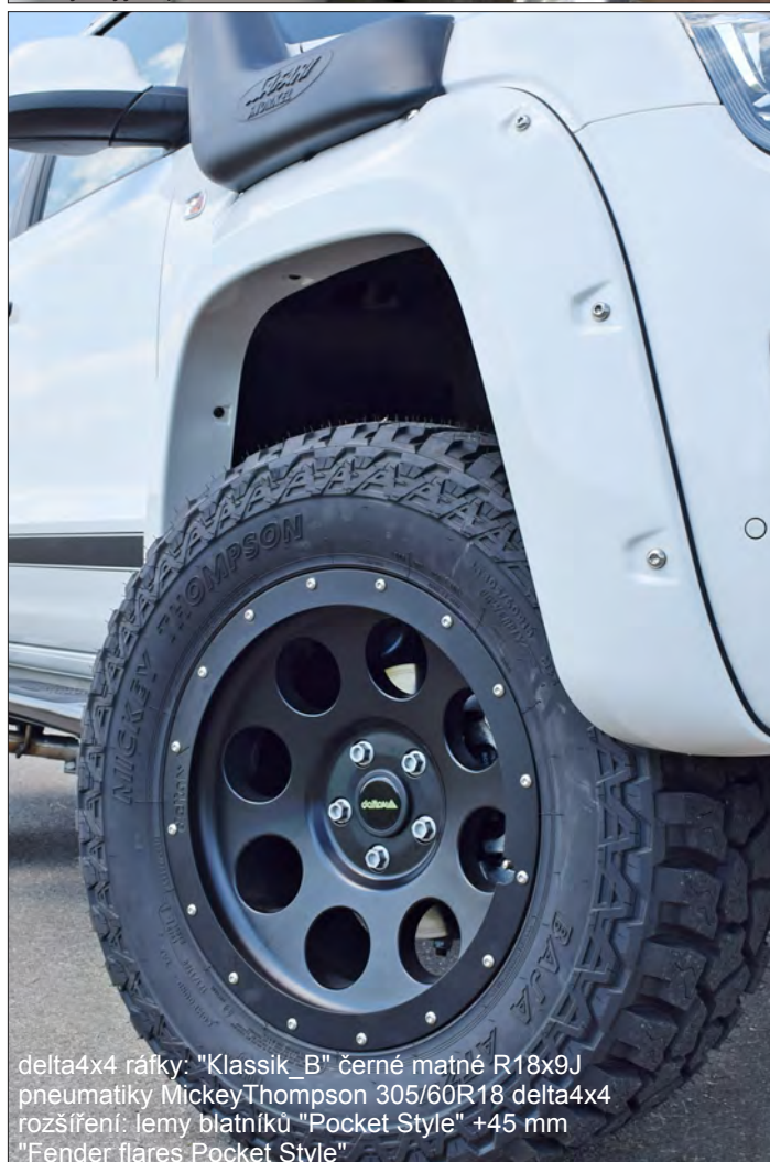
delta4x4 rozšíření: lízátka +25 mm "Lip small fender" lišty kryjící přesah disků
