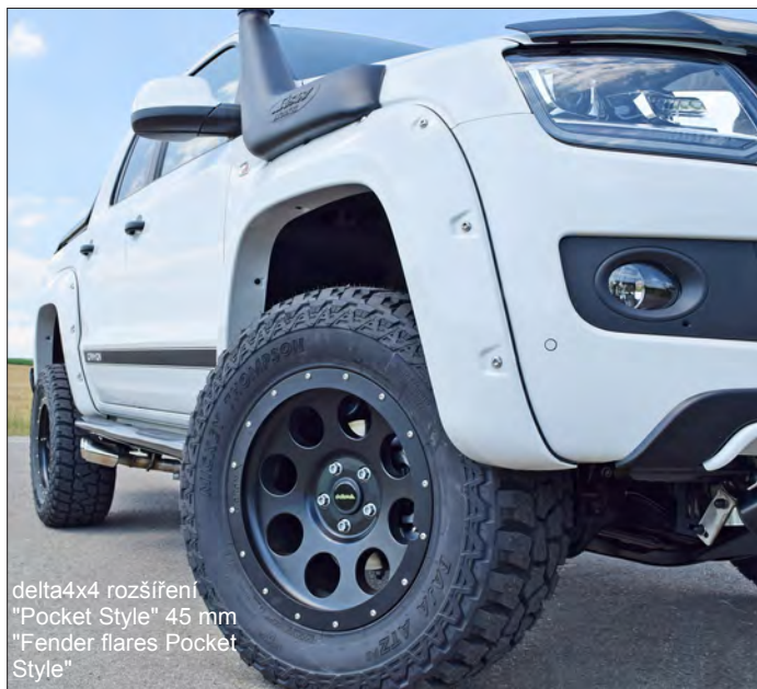
delta4x4 ráfky: "Klassik_B" černá matná R18x9J s pneu. MickeyThompson ATZ 305/60R18 delta4x4 přední rám černý, nerez 76 mm "Front bar" mm s přidavnými světlomety PIAA 520 Rallye Lights delta4x4 zvýšení: "Body lift kit" +100 mm, sportovní boční výfukový systém "SIDE PIPES Exhaust system" L+P delta4x4 rozšíření: lemy blatníků "Pocket Style" 45 mm "Fender flares Pocket Style"
