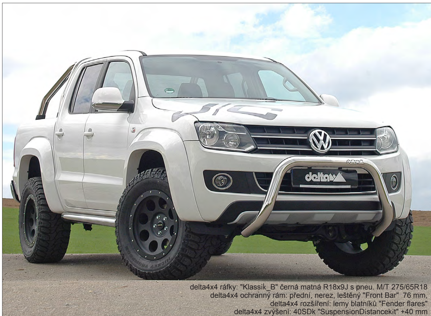
delta4x4 zvýšení: "Body lift kit" +100 mm delta4x4 ráfky: "Klassik_B" leštěné R18x9J s pneu. M/T ATZ 305/60R18 delta4x4 rozšíření: lemy blatníků "Fender flares" přídavné světlomety PIAA: dálkové 520 Lights Driving delta4x4 montážní sada pro přídavné světlomety PIAA pro ochr. rám přední
